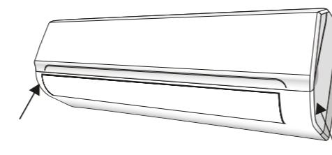
②片手で引き上げ、前面パネルを保ち、もう一方の手でエアフィルターを取り出します。
