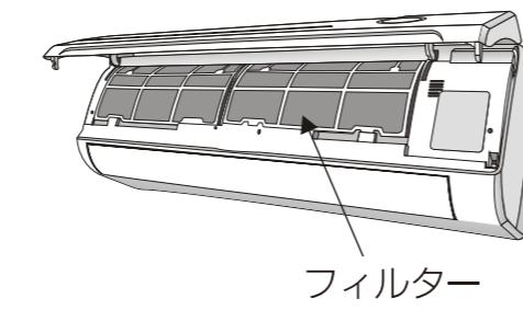
③水でフィルターを掃除してください。フィルターが油で汚れている場合は、ぬるま湯（45°C以下）で洗浄することができます。
