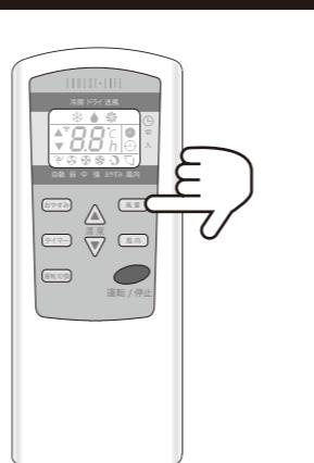
設定された風量のマークがリモコンに表示されます。
