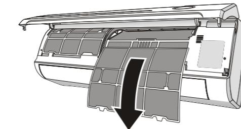
④片手で引き上げ、前面パネルを保ち、もう一方の手でエアフィルターを挿入します。
